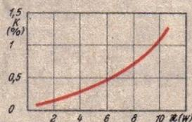
Abb. 3. Abhängigkeit des Klirrgrades im Tieftonkanal für verschiedene Ausgangsleistungen
